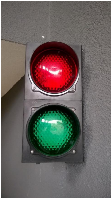
Fotografia 2. Dwukomorowy sygnalizator LED z „żarówkami” o średnicy 120mm
