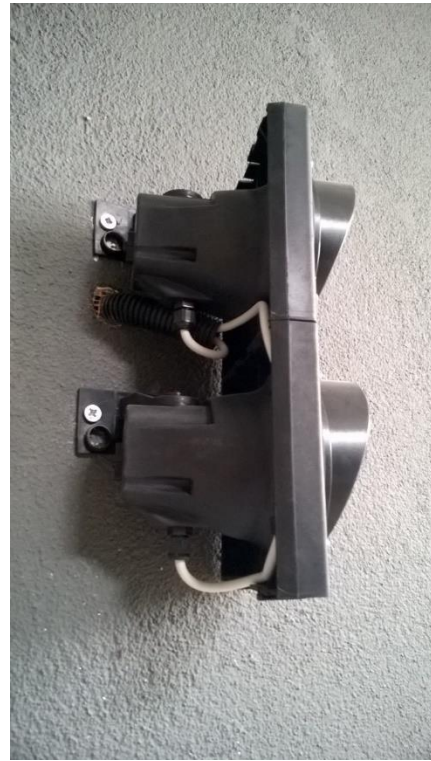
Fotografia 2. Dwukomorowy sygnalizator LED z „żarówkami” o średnicy 120mm
